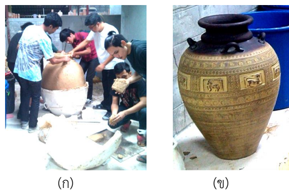
ภาพที่ 6 การขึ้นรูปดินโดยการอัดแม่พิมพ์ปลาสเตอร์ 4 ชั้น แบบแบ่งบน-ล่าง (ก) การทดลองขึ้นรูปชิ้นงานแบบกดด้วยแม่พิมพ์ปลาสเตอร์ (ข) ชิ้นงานภายหลังการขึ้นรูปและเผาผลิตภัณฑ์
