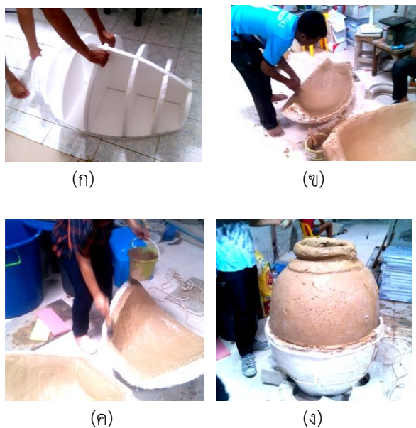
ภาพที่ 5 การขึ้นรูปดินโดยการอัดแม่พิมพ์ปลาสเตอร์ (ก) การสร้างต้นแบบปลาสเตอร์โดยใช้โครงสร้างก้างปลา ด้วยวัสดุเบา (ข) การขึ้นรูปดินโดยการอัดแม่พิมพ์
