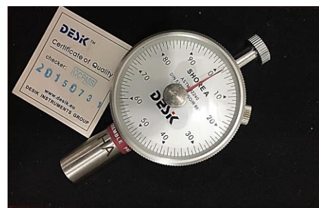
ภาพที่ 7 เครื่องวัดความแข็งแบบ Shore A ตามมาตรฐาน ASTM D2240
