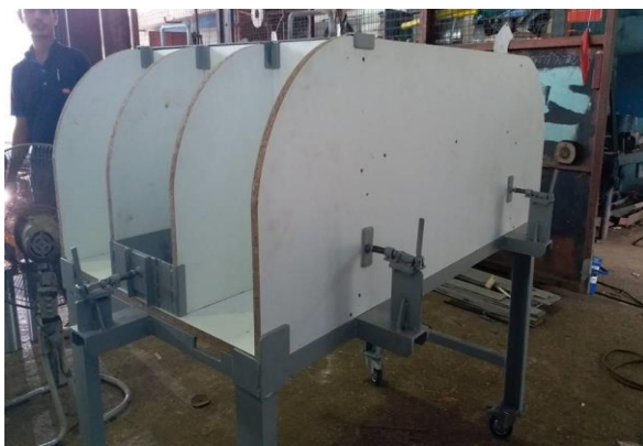
ภาพที่ 8 อุปกรณ์จับยึดชั้นงานชั้นวางสินค้า
