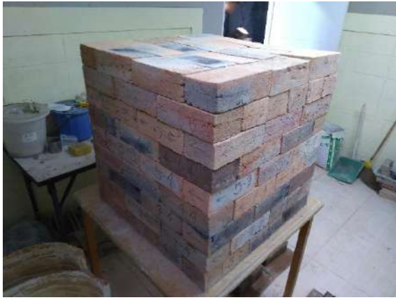
ภาพที่ 8 อิฐทนไฟหลังเผาพร้อมใช้ก่อเตาเผา
