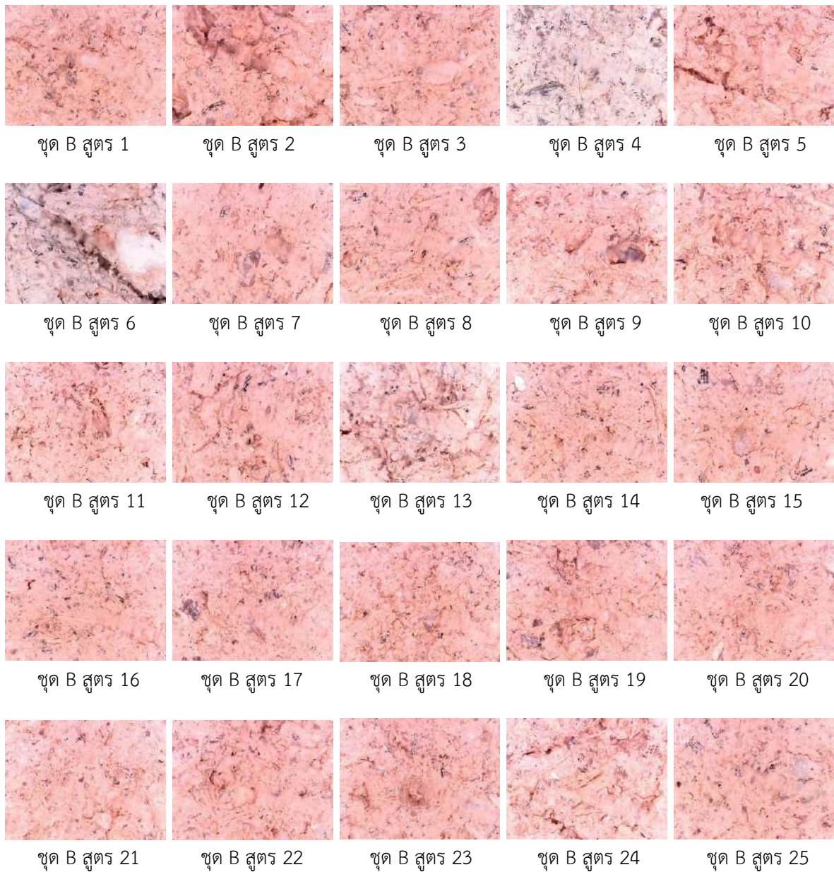
ภาพที่ 6 ลักษณะผิวอิฐทนไฟแต่ละสูตร จากอิฐทนไฟ ชุด B
