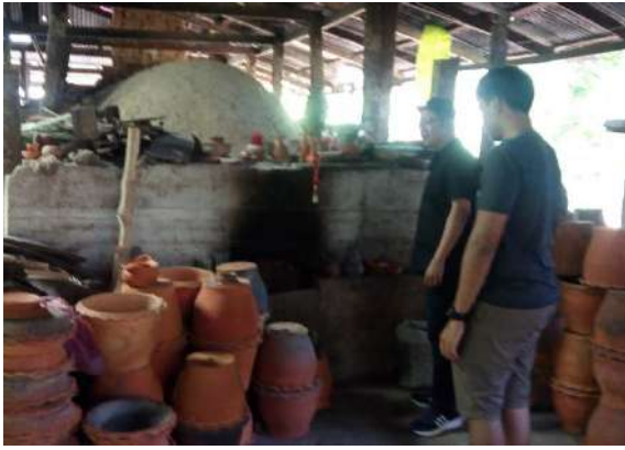
ภาพที่ 9 ทางเดินลมและห้องเผาผลิตภัณฑ์ใช้รูปทรงพัฒนาจากเตามังกรพื้นบ้าน(ธนบดี) จังหวัดลำปาง
