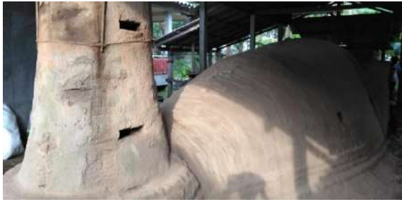
ภาพที่ 22 โครงสร้างปล่องไฟทางเดินลมและห้องเผา ต้นแบบจากเตามังกรพื้นบ้าน (ธนบดี)
