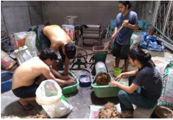
ภาพที่ 5 การรีดผสมดินทนไฟจากอัตราส่วนผสมที่เหมาะสมสำหรับทำอิฐเตาเผาไฟต่ำ
