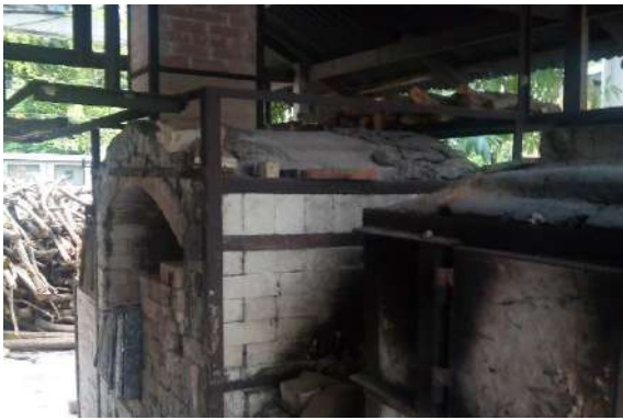
ภาพที่ 10 ช่องเผาและเติมเชื้อเพลิงใช้โครงสร้างเตาแบบฝรั่งเศสจากเตาเผาพื้นบ้านชุมชนบ้านด่านเกวียน จังหวัดนครราชสีมา
