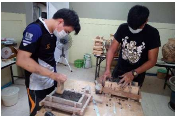
ภาพที่ 6 การอัดขึ้นรูปอิฐทนไฟเป็นรูปแบบต่าง ๆ ด้วยแม่พิมพ์ไม้
