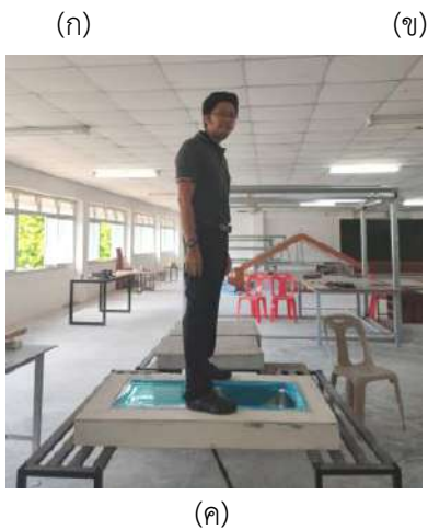
ภาพที่ 7 เคา์นเตอร์ซิงค์ล้างจานจากโพนคอนกรีตเสริมไม้ไผ่
