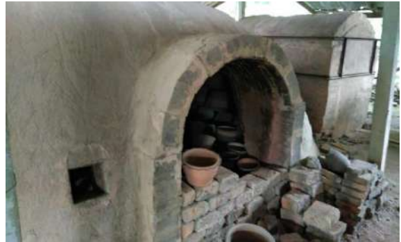
ภาพที่ 20 การปิดทางบรรจุผลิตภัณฑ์เตาเผาไฟต่ำเพื่อเตรียมเผา
