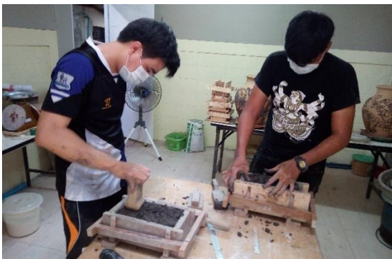
ภาพที่ 6 การอัดขึ้นรูปอิฐเหนียวเป็นรูปแบบต่าง ๆ ด้วยแม่พิมพ์ไม้
