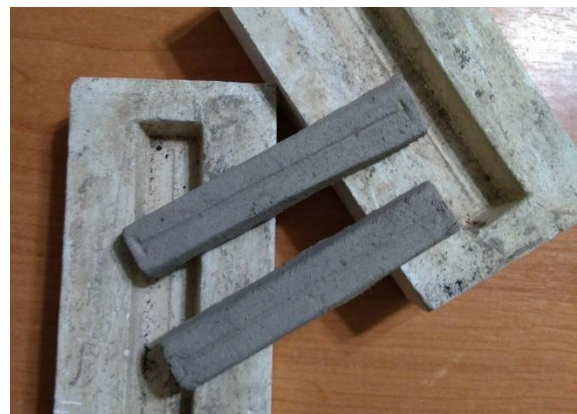
ภาพที่ 4 การขึ้นรูปแท่งทดสอบคุณสมบัติทางกายภาพ อัตราส่วนผสมของดินทนไฟ
