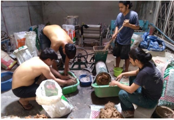
ภาพที่ 5 การรีดผสมดินเหนียวจากอัตราส่วนผสมที่เหมาะสมสำหรับทำอิฐเตาเผาไฟต่ำ
