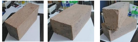
(1) อิฐก้อนผนังเตาและก้อหลังคาเตา (2) อิฐหัวขวาน
