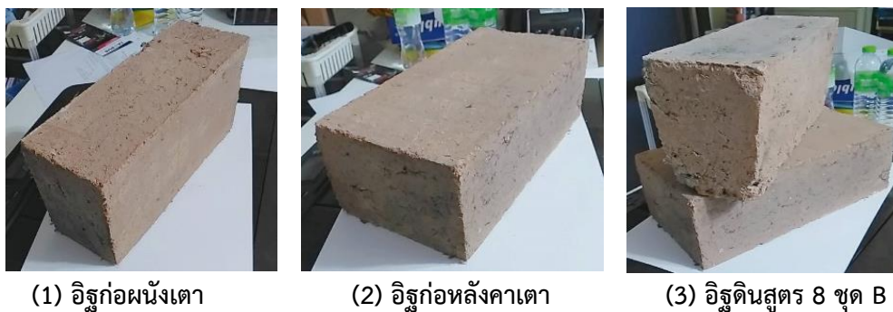
ภาพที่ 7 ตัวอย่างอิฐทนไฟสูตร B13 จากอัตราส่วนผสมดินทนไฟ ชุด B
