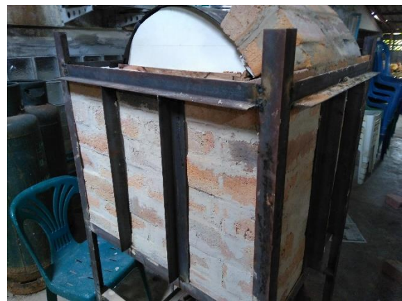
ภาพที่ 12 การใช้โครงเหล็กถัดผนังเตาเผาเพื่อรักษาโครงสร้าง
