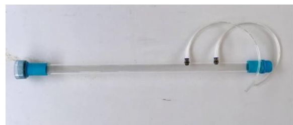
(ก) ท่อแยกน้ำมันมะพร้าวที่ออกแบบและพัฒนา
