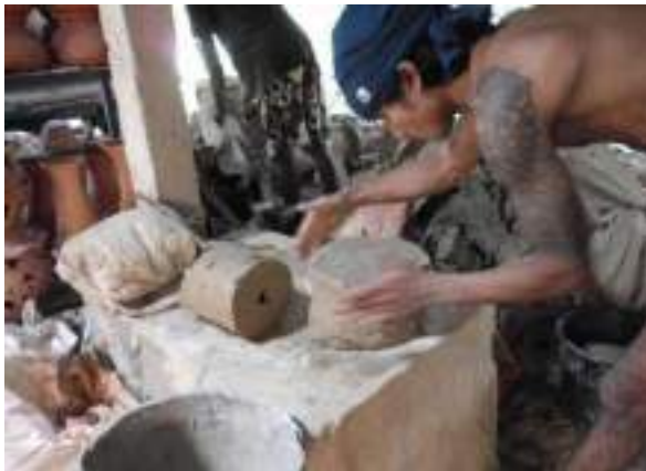
ภาพที่ 6 การนวดดินด้วยมือ
