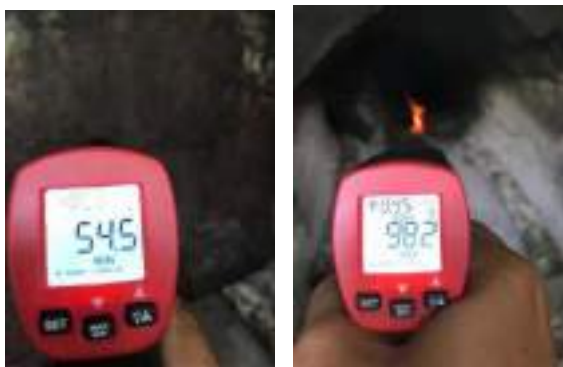
ภาพที่ 5 อุณหภูมิบริเวณห้องเผาไหม้และห้องรวมวัน
