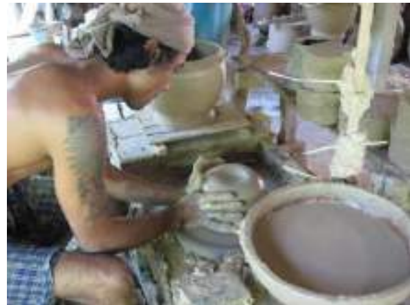
ภาพที่ 8 การทดลองขึ้นรูปผลิตภัณฑ์ด้วยแป้นหมุนของชุมชน (บ้านนางจำเป็น รัษฎาเมือง)
