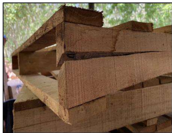
ภาพที่ 2 รูปแบบงานเสียหัวไม้แตกขณะยิง
