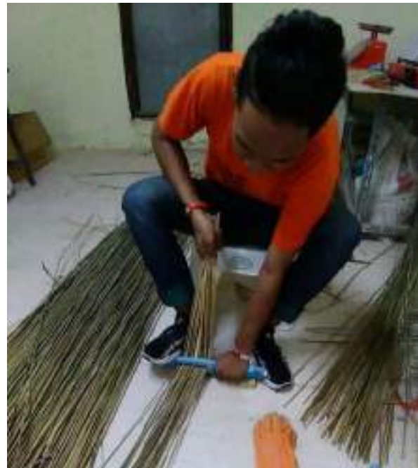
ภาพที่ 13 การรีดเพื่อเตรียมฟั่นเชือกสำหรับการขึ้นรูปผลิตภัณฑ์
