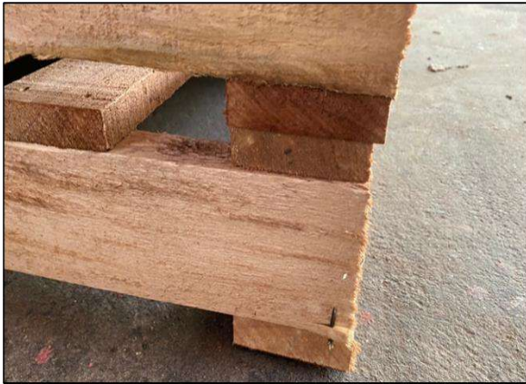
ภาพที่ 3 รูปแบบของเสียในการยิงตะปูปิดเบี้ยว
