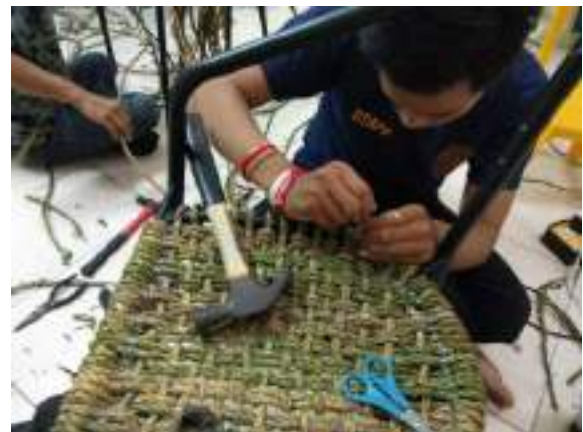
ภาพที่ 24 ลงโครงเชือกกระจูดและสายเส้นนอนเพื่อวางพื้นของเฟอร์นิเจอร์
