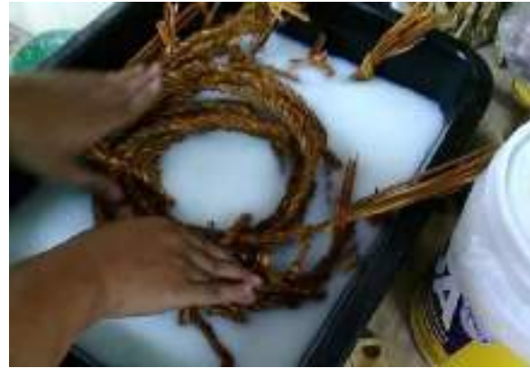
ภาพที่ 17 การแช่เชือกกระจูดด้วยกาวลาเท็กซ์เพื่อเพิ่มความเหนียวและลดเชื้อรา
