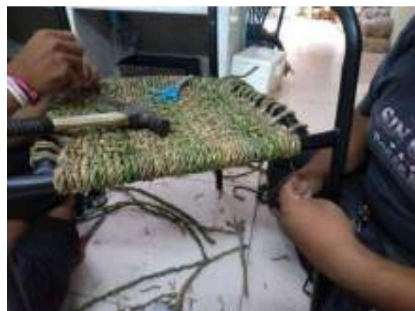
ภาพที่ 25 เก็บรายละเอียดเส้นนอนให้เรียบและจัดระยะห่างให้เหมาะสม
