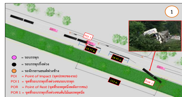
ภาพที่ 3 ผังลำดับการเกิดอุบัติเหตุ 1 รถบรรทุกกึ่งพ่วงชนท้ายรถบรรทุก
