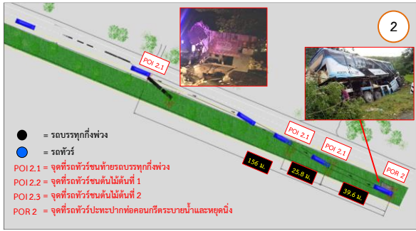
ภาพที่ 4 ผังลำดับการเกิดอุบัติเหตุ 2 รถทัวร์ชนท้ายรถบรรทุกกึ่งพ่วง
