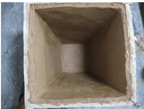
ภาพที่ 12 การทดลองขึ้นรูปผลิตภัณฑ์ด้วยการอัดแม่พิมพ์ด้วยดินจากผลการทดลอง
