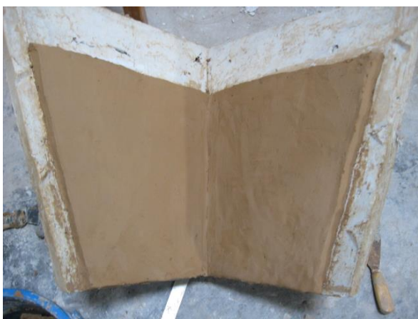
ภาพที่ 11 การทดลองขึ้นรูปผลิตภัณฑ์ด้วยการอัดแม่พิมพ์ด้วยดินจากผลการทดลอง
