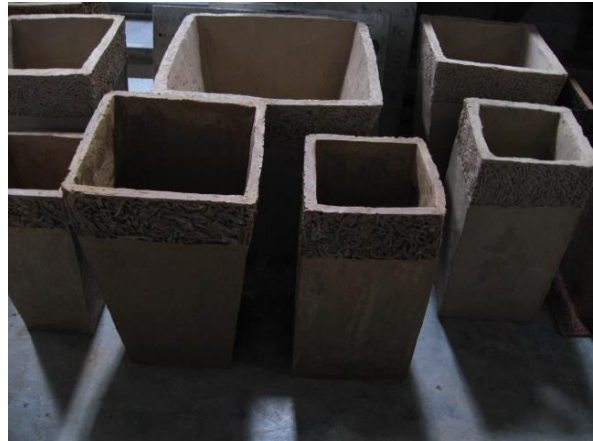
ภาพที่ 13 ผลิตภัณฑ์จากการอัดแม่พิมพ์ด้วยดินทดลอง
