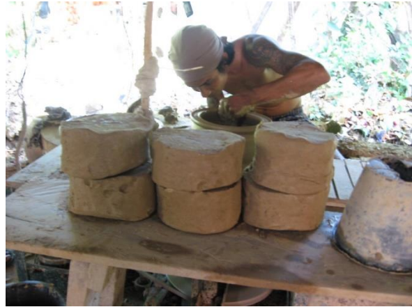
ภาพที่ 7 การทดลองขึ้นรูปผลิตภัณฑ์ขนาดใหญ่ด้วยขั้นตอนการขึ้นรูปที่พัฒนาขึ้นและดินจากผลการทดลอง
