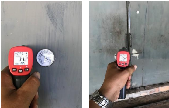
ภาพที่ 4 เครื่องมือวัดอุณหภูมิ แบบอนาล็อก และ แบบดิจิตอล
