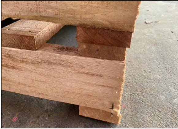
ภาพที่ 3 รูปแบบของเสียในการยิงตะปูปิดเปี้ยว
